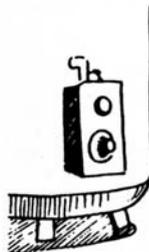
El agua puede dañar la válvula de control. Cuando se moje la válvula, hagala reemplazar por una nueva.
